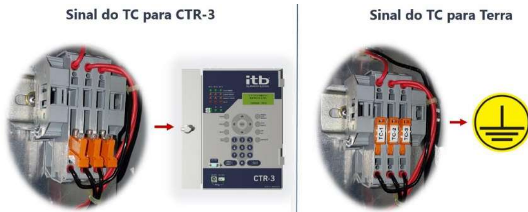
Figura 6: Procedimento de curto-circuitar os TCs.
